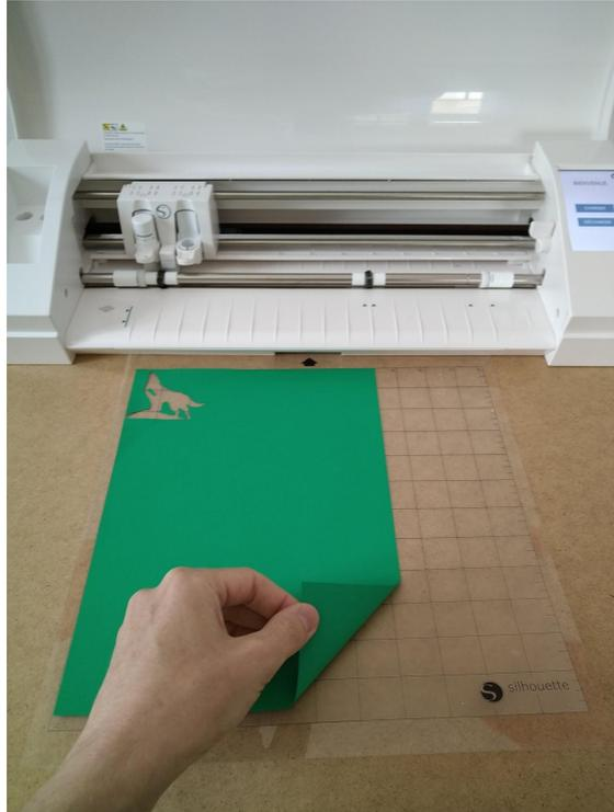
10. Remettre la protection sur le tapis (le côté brillant de la protection contre le côté collant du tapis)
