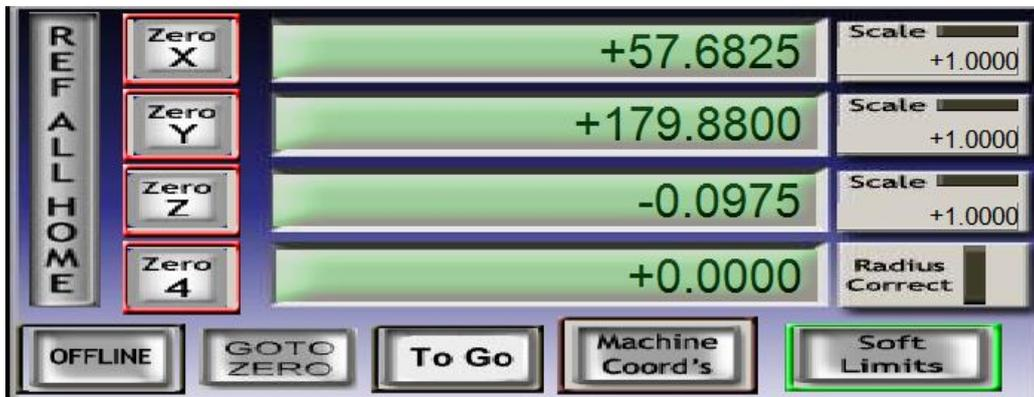
L'affichage indique la position relative (en millimètres) de chaque axe de la machine : X, Y et Z.
